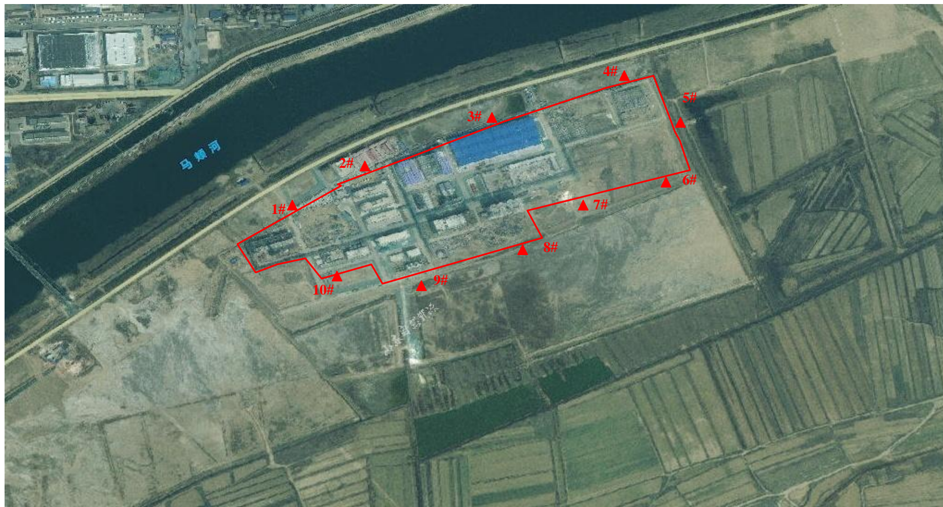
图 7-2 噪声监测布点示意图
